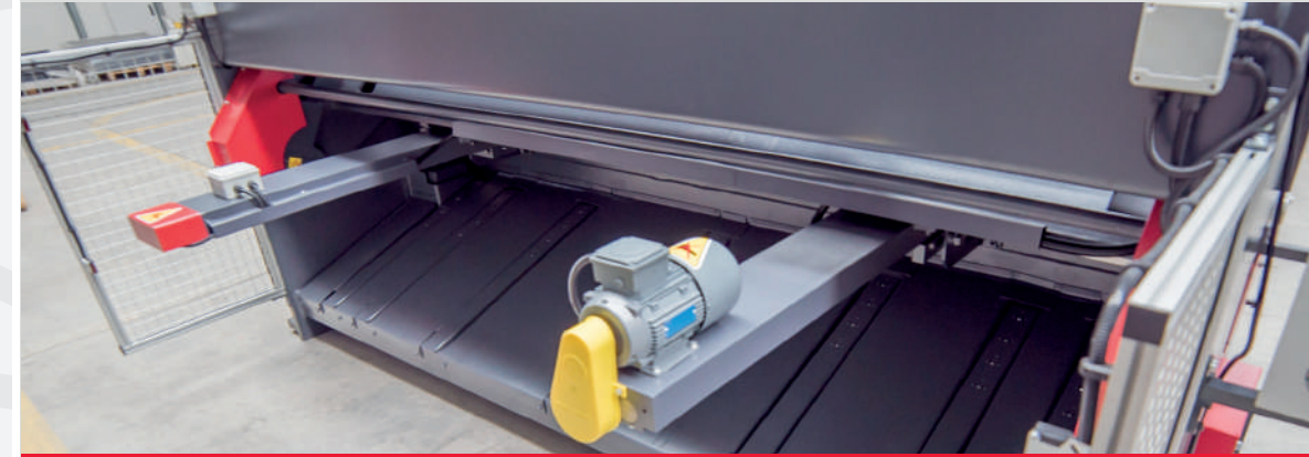
± 0,1mm hassasiyetli motorlu arka dayama
