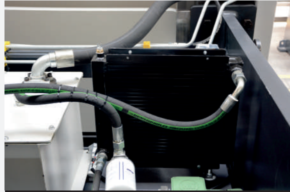
Hidrolik Yağ Soğutucu Sistemi
