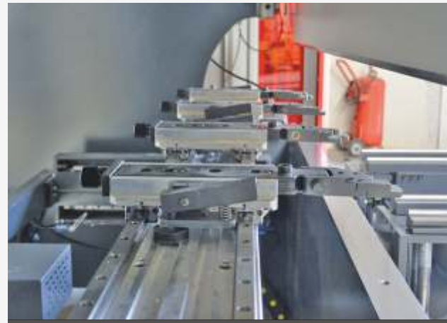
2-3-4-5-6 Eksen Arka Dayama için İlave Dayama Dilleri
