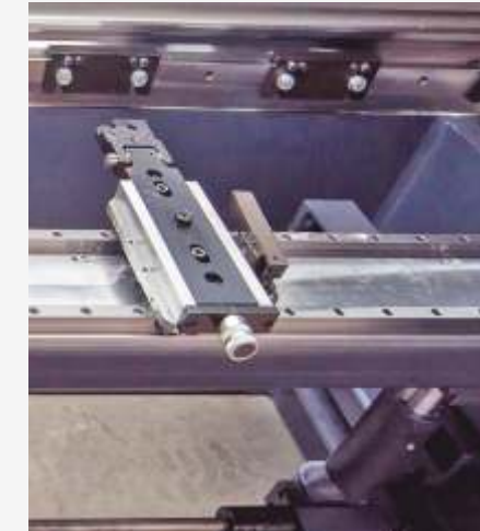
Çift Lineer Kızaklı Ağır Tip Arka Dayama
