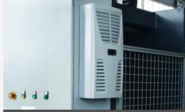
Elektrik Kabin Soğutma Sistemi
